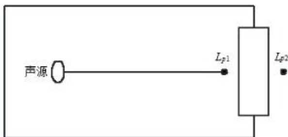
图 4.4-1 室内声源等效为室外声源图例
